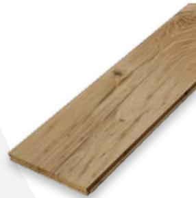
Verlegefertige Landhausdielen massiv mit Oberflächen, geschnitten von Mittellagen alter Eichenbalken- und Blockwänden, kammergetrocknet (12%  $\pm$ 2%), ausgebessert, geschliffen, längsseitig Nut/Feder, paketweise sortiert
