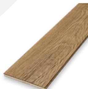
Verlegefertige 3-Schicht-Landhausdielen mit handgeschruppten Oberflächen, geschnitten von Mittellagen alter Eichenbalken- und Blockwänden, ausgebessert, Oberfläche handgehobelt, gebürstet, längsseitig Nut/Feder, stirnseite Nut, paketweise sortiert
